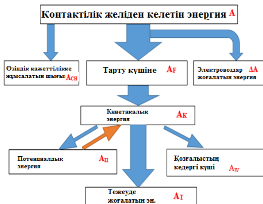
Сурет 1.5 - Электржылжымалы құрамының энергетикалық сұлбасы [9]
