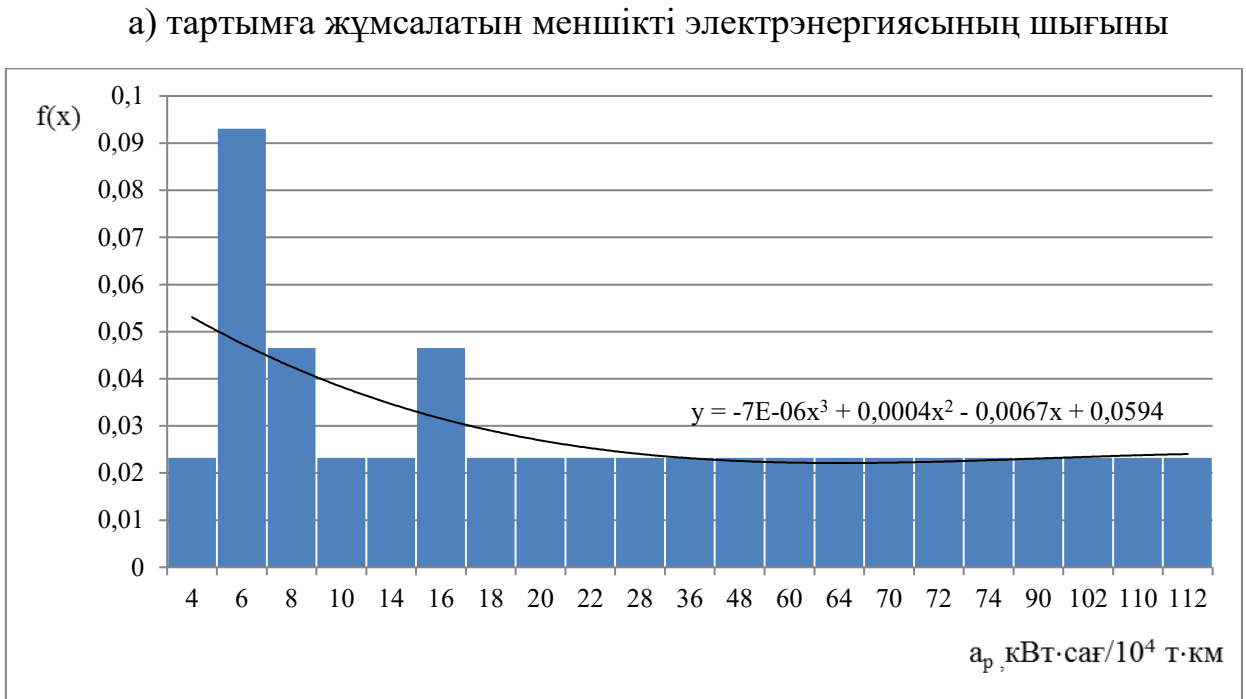
Сурет 2.21 - Шу - Сарыағаш теміржол бөлімшесі бойынша тартым шығынының және рекуперациялық электр энергиясының меншікті көрсеткіштерінің қалыпты таралу заңдылығының гистограммасы
