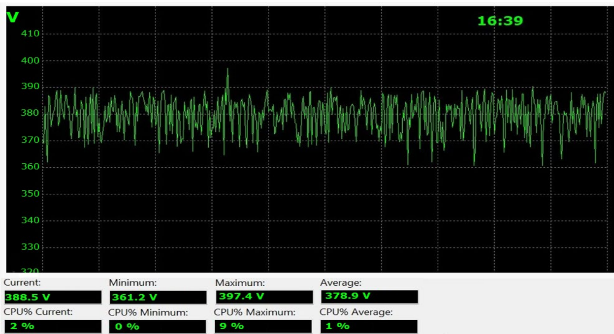
Сурет 4.4 - Өзіндік қажеттіліктегі тізбектің кернеуінің көрсеткішінің фрагменті
