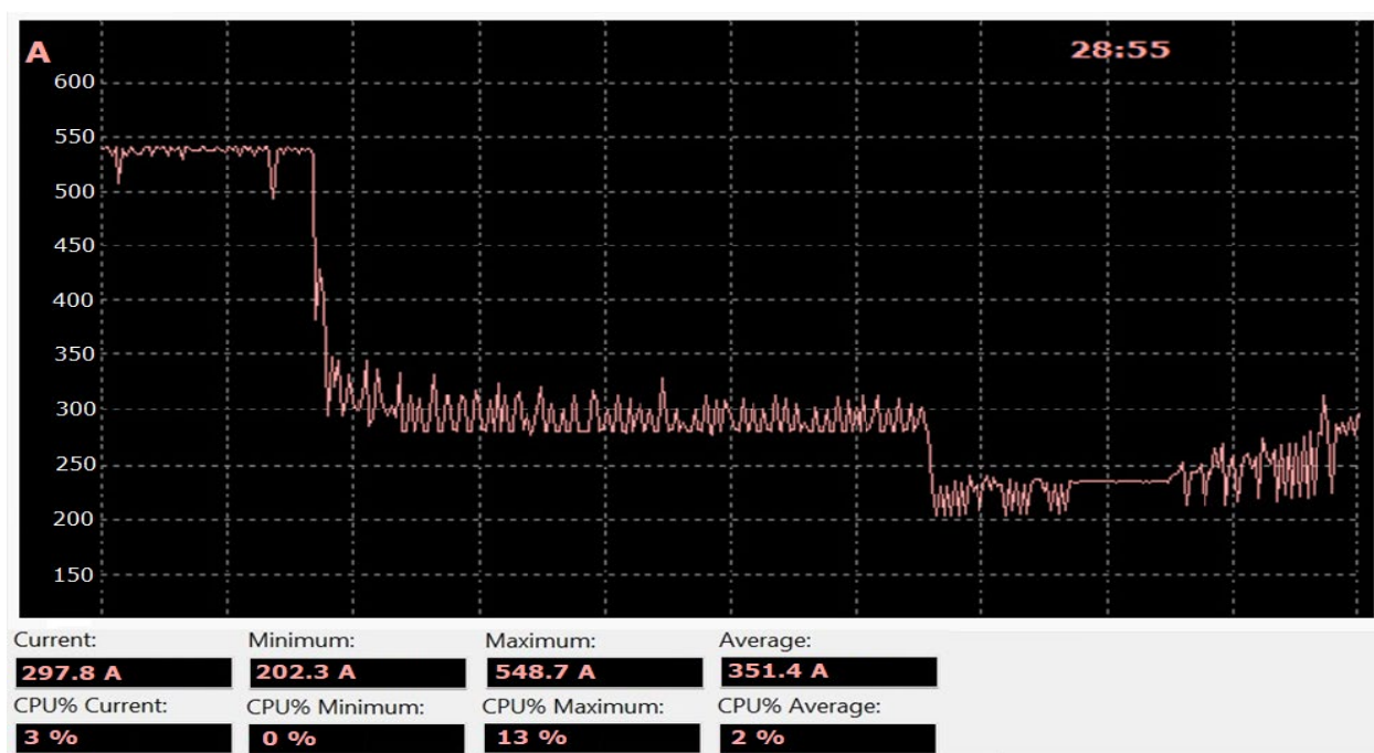
Сурет 4.5 - Өзіндік қажеттіліктегі тізбектің тоғының көрсеткішінің фрагменті
