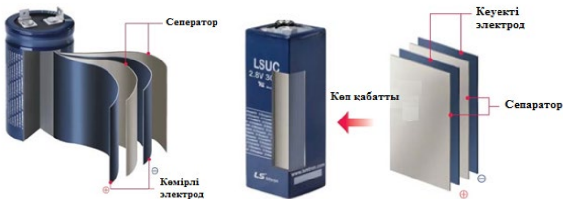
Сурет 3.6 - Суперконденсатордың құрылымы
